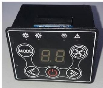
При использовании переключателя скорости вентилятора испарителя компрессор срабатывает при включении одной из скоростей. При установке переключателя в положение «0» кондиционер выключается. Положение «1» соответствует минимальной, «2» - средней «3» - максимальной скорости вентилятора испарителя.
