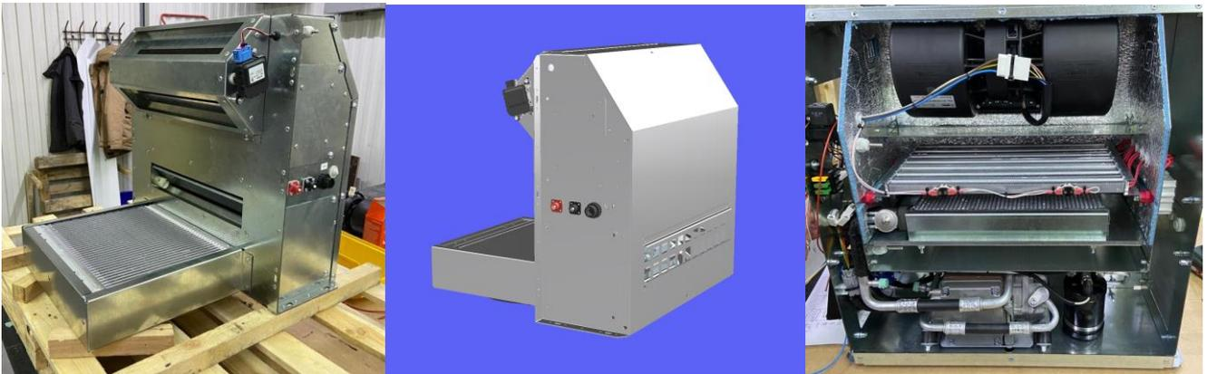
Климатическая система водителя (КСВ) предназначена для поддержания температурного режима в кабине водителя транспортного средства.
